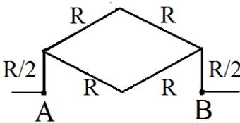
Рассмотрим верхнюю половину схемы. Сопротивление ромба находим как сопротивление параллельного соединения двух проводников сопротивлением  $2R$ , тогда  $R_1 = \frac{2R \cdot 2R}{2R + 2R} = R$ .
