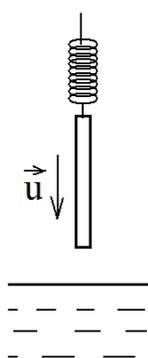
3. Над поверхностью водоёма на пружине подвешена свая с квадратным сечением  $S$  длины  $L$ . Её начинают медленно со скоростью  $u = 0,1\text{ м/с}$  опускать и каждую секунду фиксируют удлинение пружины  $x$ . Результаты измерений представлены на графике. По этим данным определите площадь сечения сваи. Жёсткость пружины  $k = 400\text{ Н/м}$ .
