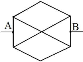
5. Из проволоки с удельным сопротивлением  $\rho = 1,2 \cdot 10^{-6} \text{ Ом} \cdot \text{м}$  и площадью сечения  $S = 0,5 \text{ мм}^2$  изготовлена фигура в форме правильного шестиугольника с двумя диагоналями. Длина одной стороны шестиугольника  $L = 10 \text{ см}$ . Определить сопротивление между точками А и В получившейся фигуры.
