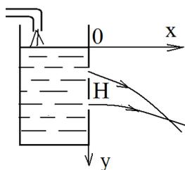
5. В стенке бочки с водой просверлены одно над другим 2 отверстия одинаковой площади  $S = 0,1\text{ см}^2$ . В бочку каждую секунду вливается  $70\text{ см}^3$  воды. Найти координаты точки пересечения вытекающих из отверстия струй. При каком условии точка пересечения вытекающих из отверстия струй воды будет оставаться неподвижной? Найти координаты этой точки в предложенных на рисунке осях. Расстояние между отверстиями  $H = 50\text{ см}$ .
