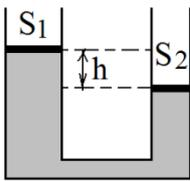
1. В двух сообщающихся сосудах налита вода. Сосуды имеют площади  $S_1=2S$  и  $S_2=S$ . Масса поршней на поверхностях воды в сосудах различна. В начальный момент разность уровней в сосудах равна  $h$ . Если на первый поршень налить слой масла, то поршни окажутся на одном уровне. Если масло перелить на второй поршень, то разность уровней будет  $H=15\text{см}$ . Определите начальную разность уровней  $h$ .
