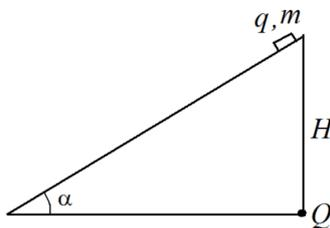
3. Заряженный диск ( $q = 5 \text{ нКл}$ ) массой  $m = 10 \text{ г}$  положили на вершину гладкой наклонной плоскости, образующей с горизонтом угол  $\alpha = 37^\circ$ . В вершине прямого угла треугольника закреплён заряд  $Q = 6 \text{ мКл}$ . Определите скорость шайбы у основания наклонной плоскости. Высота  $H = 0,5 \text{ м}$ . Ускорение свободного падения  $g = 10 \text{ м/с}^2$ ,  $\sin 37^\circ = 0,6$ .
