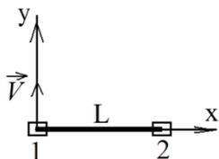
5. Два стержня соединены под прямым углом. Тело 1 и 2 соединены шарнирно стержнем длины  $L=20$  см. Первое тело начинает подниматься со скоростью  $V = 2$  см/с. Найти координаты первого и второго тела спустя 3 с от начала движения.
